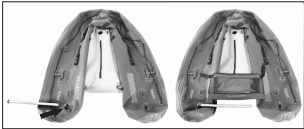
2. Nájdite „2-dielnu montážnu rúrku“: pozostáva z jednej dlhej a jednej krátkej rúrky. Vložte dlhú rúrku cez jednu stranu montážneho otvoru trupu.
